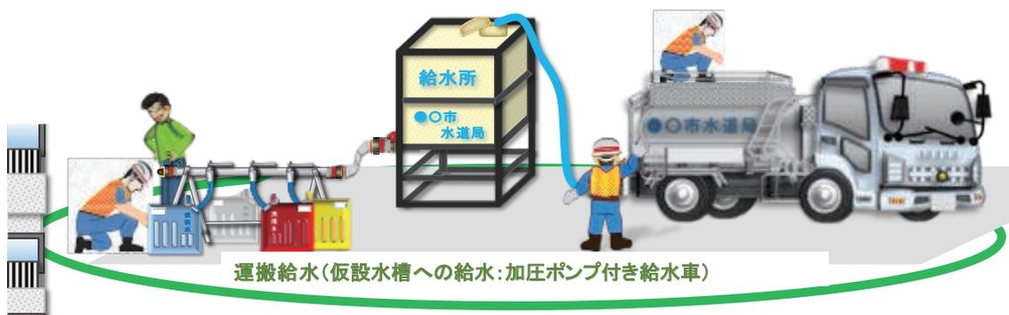
図 1-2 仮設水槽による給水
