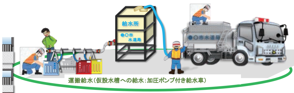
図1-2 仮設水槽による給水
